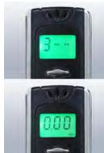
測定結果表示中にボタンを長押しして過去5件の履歴を閲覧できます。
